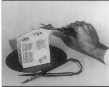
Zdjęcie nr 10 Nożyczki, których uchwyty są złączone paskiem elastycznym z syntetyku ułatwiającym postępowanie się nimi.
