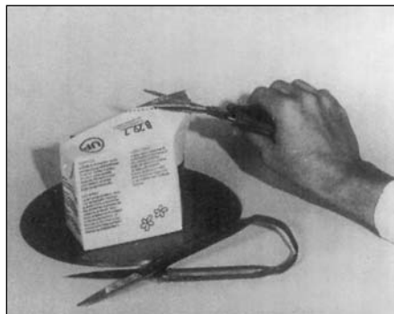
Zdjęcie nr 10 Nożyczki, których uchwyty są połączone paskiem elastycznym z syntetyku ułatwiającym postępowanie się nimi.
